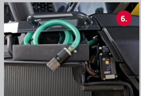
1. Kraftstofffilter mit Wasserabscheider / 2. Klimakompressor / 3. Luftfilter / 4. Batterie / 5. Lüfterriemen / 6. Betankungspumpe
