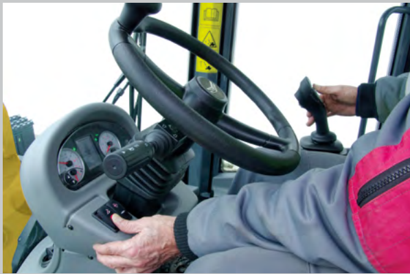
Einstellung der Oelmenge des dritten und vierten Kreises ueber das Display.
