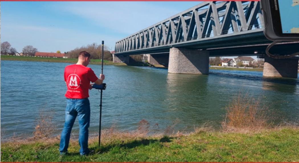
GNPS-42 System zur Echtzeitpositionierung (RTK) für Aufnahme und Absteckung von Punkten und geometrischen Formen bei
