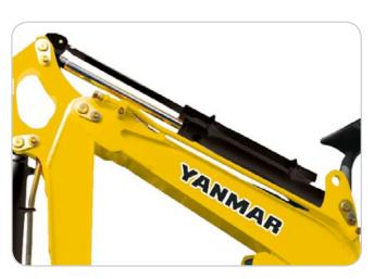
Erster Zusatzkreis für Anbaugeräte einseitig beaufschlagt für Hammer oder zweiseitig beaufschlagbar für Erdbohrer, Schwenklöffel
