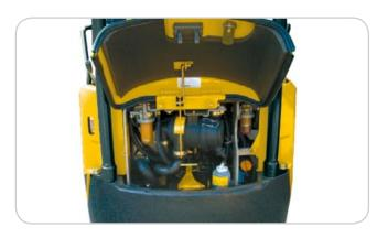
> Leichter Zugang zu den Wartungspunkten: zu den einzelnen Motorelementen, den Hydraulikpumpen...
