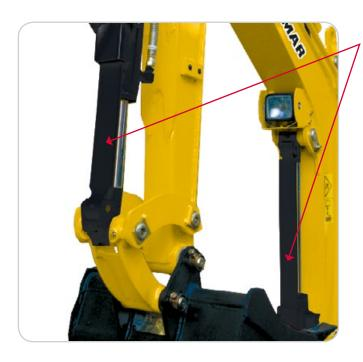
> Vollständiger Schutz des Zylinder (Hebel + Zylinder) mit hoch-elastischen Stahlblechen um eventuelle Schläge abzufedern.
